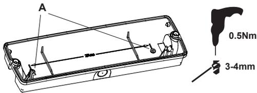
Bohren Sie wie angegeben und verwenden Sie Dübel + Schrauben, um das Gehäuse an der gewünschten Position zu befestigen.
