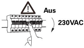
Stellen Sie sicher, dass die Spannungsversorgung abgeschaltet ist, bevor Sie die Notleuchte installieren.
